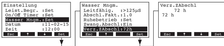
Im Änderungsdialog legen Sie die Betriebsdauer fest, nach welcher eine automatische Zwangsabschlammung ausgeführt wird.
